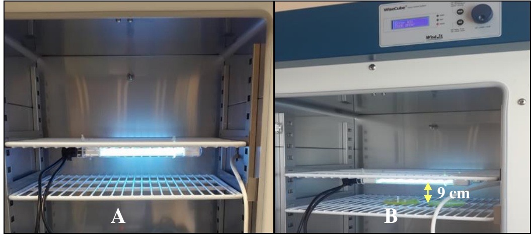
Şekil 4.1. UV-C uygulama işlemi için dizayn edilen ortam, A: UV-C ışık kaynağının inkübatör içerisine yerleştirilmesi, B: Petri kaplarında yumurta sarısına UV-C ışık muamelesi
