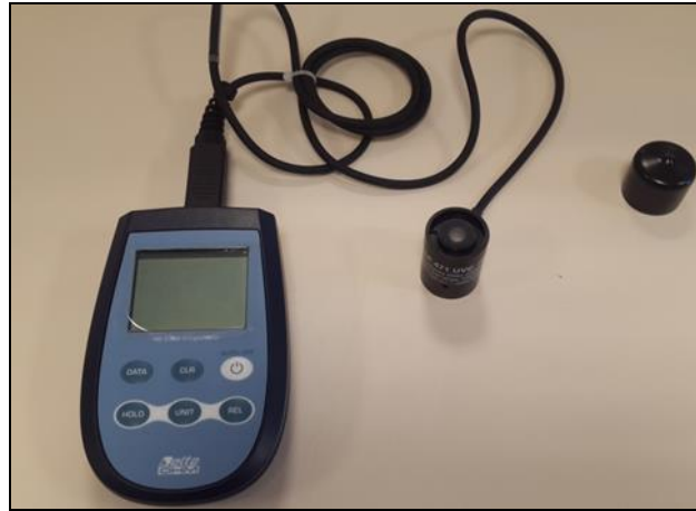
Şekil 4.2. Uygulanan ultraviyole ışığın dozunu ölçmede kullanılan radyometre ve UV-C probu
