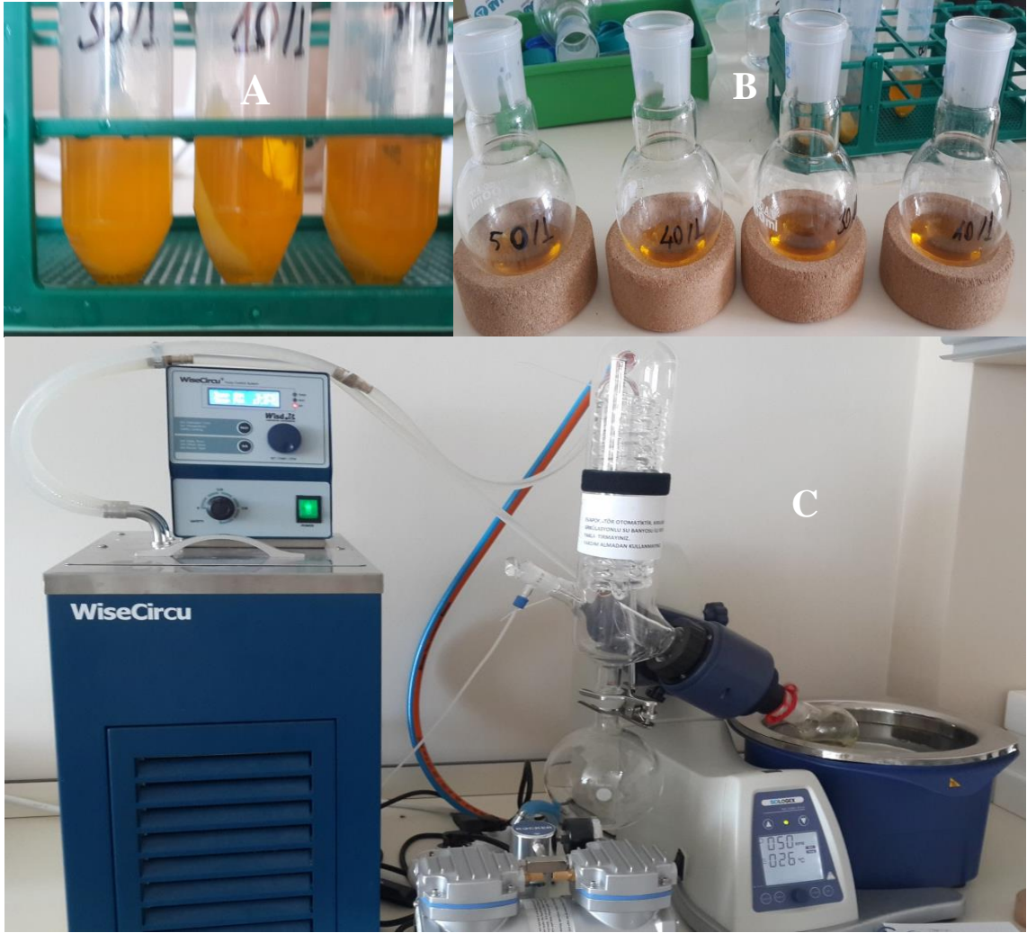
Şekil 4.8. Liyofilize örneklerde yağ ekstraksiyonu, A: Kloroform-metanol sonrası karışım, B: Üst fazın metanolik hidroklorik asit ve hekzan ile karıştırılma aşaması ve C: Hekzanın dönele evaporatörde uçurulması
