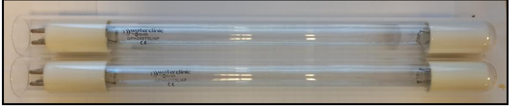
Şekil 4.3. Uygulamada kullanılan kuvars kılıflı UV-C lambalar
