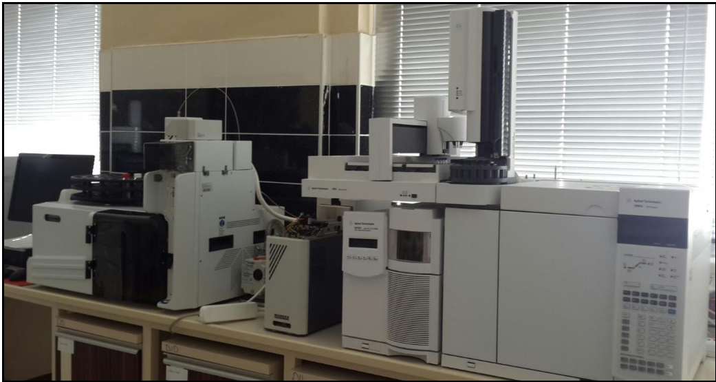
Şekil 4.11. UV-C ışığa maruz kalan yumurta sarılarında yağ asidi kompozisyonunun belirlenmesinde kullanılan GC-MS cihazının görüntüsü
