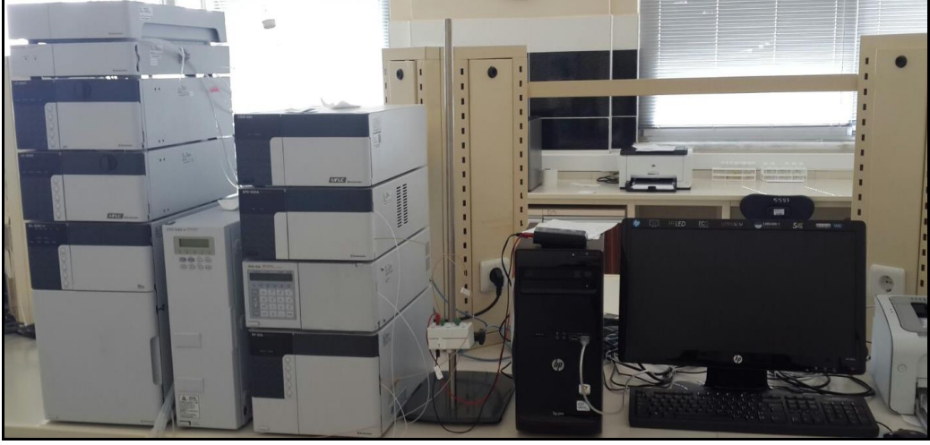
Şekil 4.10. UV-C ışığa maruz kalan yumurta sarılarında lutein, zeaksantin ve kantaksantin kompozisyonunun belirlenmesinde kullanılan yüksek performanslı sıvı kromatografisi (HPLC) cihazının görüntüsü
