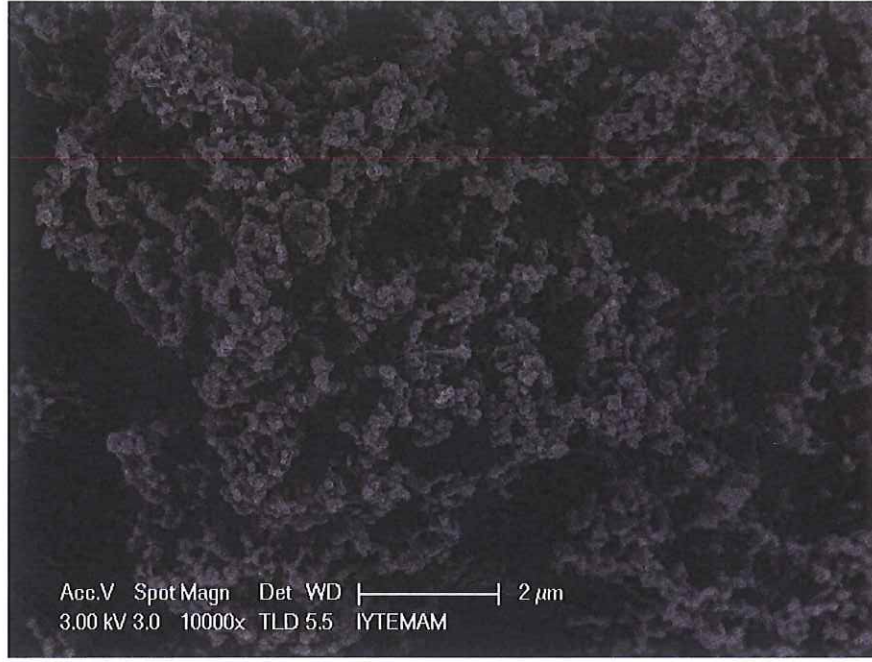
Şekil 4.7. Cd (II) çözeltisiyle muamele edilmiş kompozite ait SEM mikrografı
