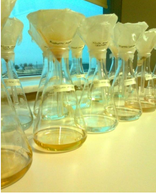
Şekil 3.12. Kaba filtre kağıdından huni yardımı ile süzme işlemi
