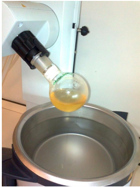
Şekil 3.14. Döner buharlaştırıcıda metanolü uçurma işlemi
