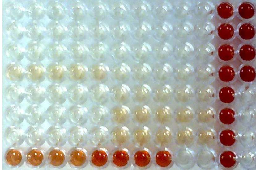
Şekil 3.22. Toplam flavonoid içeriğini belirlemek için yapılmış bir plaka
