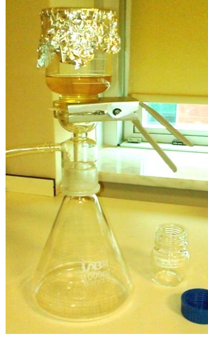
Şekil 3.13. Filtrasyon sistemi ile süzme işlemi
