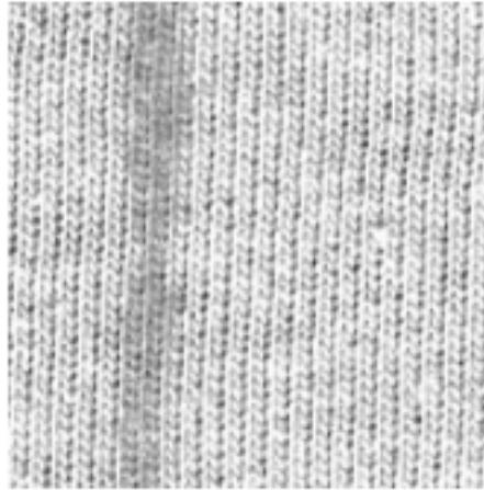
Şekil 2.8. Boyuna yönde yağ lekesi
