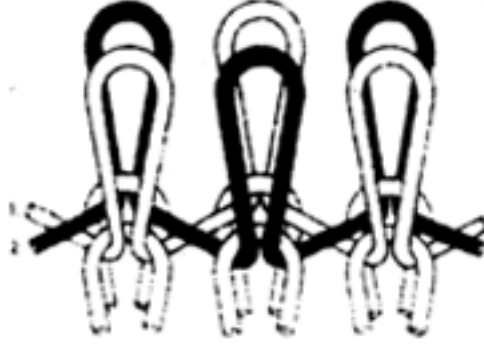
Şekil 2.6. İnterlok örgü yapısı (Bayazıt, 1999)
