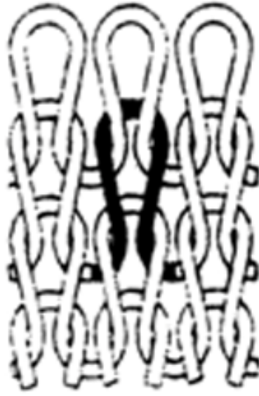
Şekil 2.2. Düz örgü yapısı (Bayazıt, 1999)
