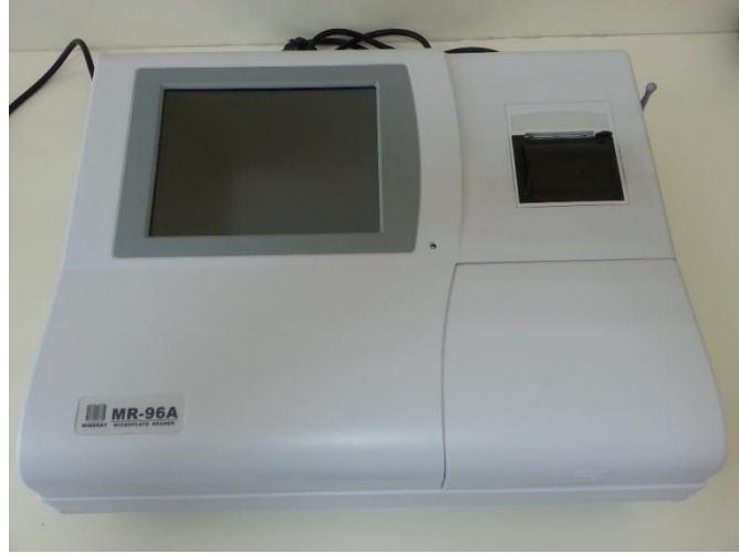
ekil 3.5. Ara t,rmada kullan,lan ELISA mikroplaka okuyucu (MR-96A, Shenzhen Mindray Bio-Medical Electronics Co., Ltd., Çin)
