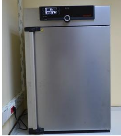
Şekil 3.2. Fanlı hava sirkülasyonlu etüv tipi kurutucu
