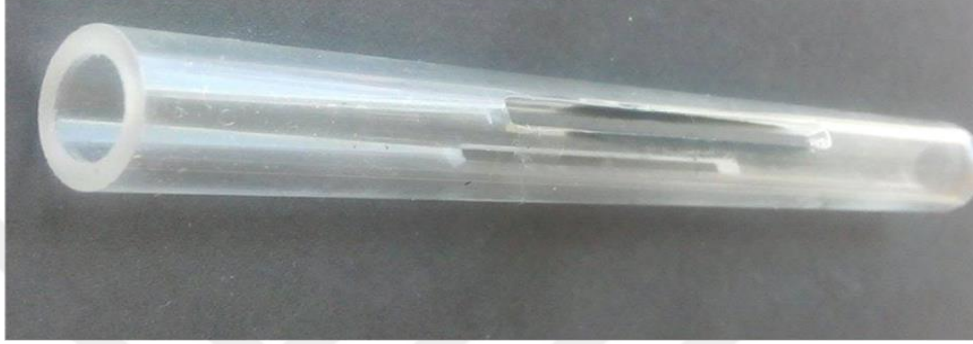
Şekil 1.8. Yarıklı kuvars boru.
