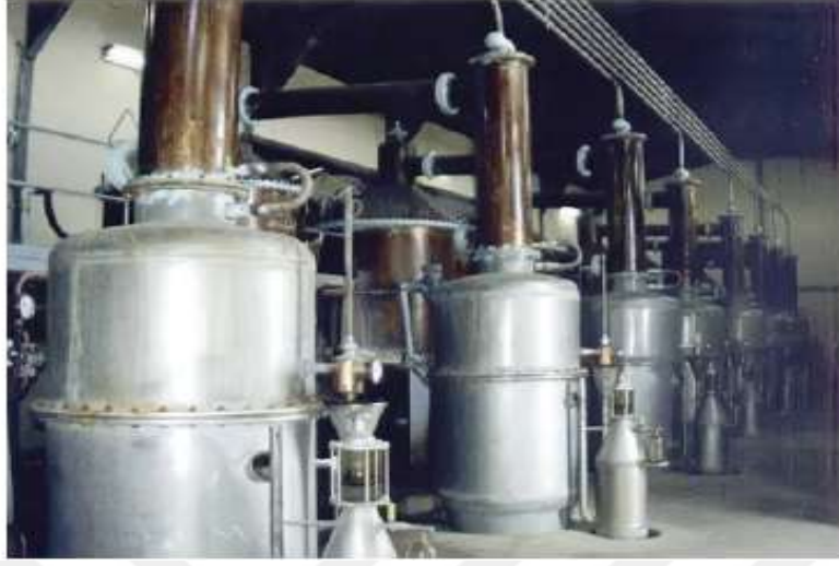
Şekil 2.3. Su destilasyonu sistemi (Başer, 2010)
