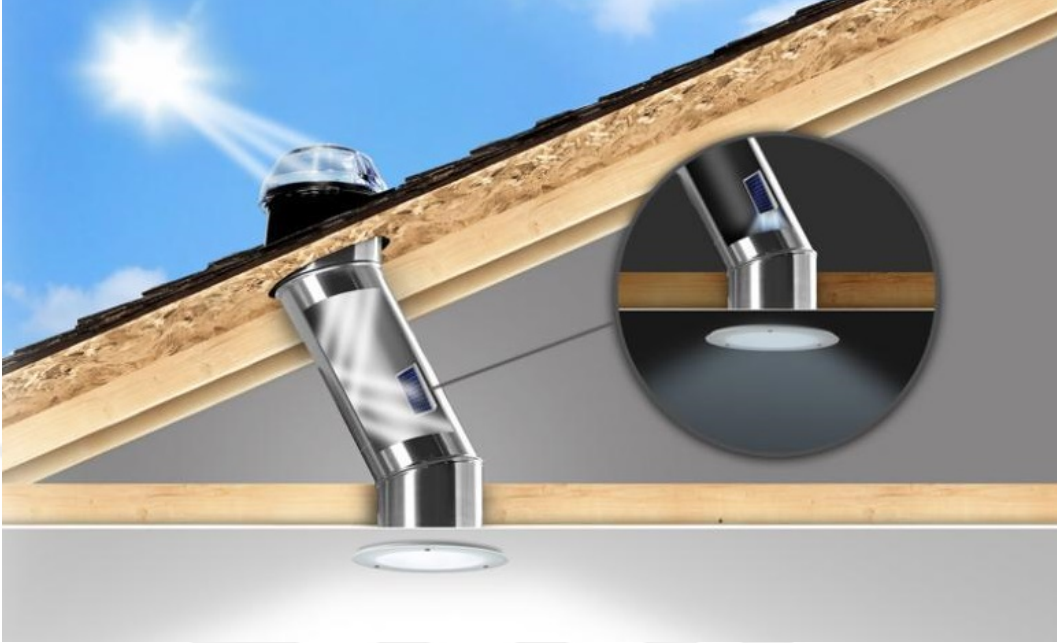
Şekil 2.3. Işık borusu (güneş tüpü) sistemleri (Solatube, 2017)
