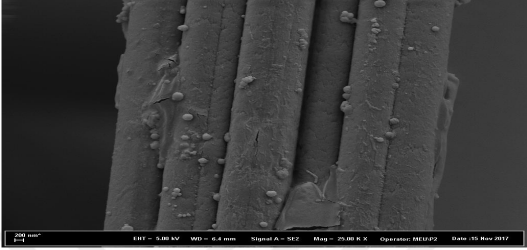
Şekil 4.20. Karanfil uçucu yağı içeren sargı bezinin 25.00 K X oranında büyütülmüş SEM görüntüsü
