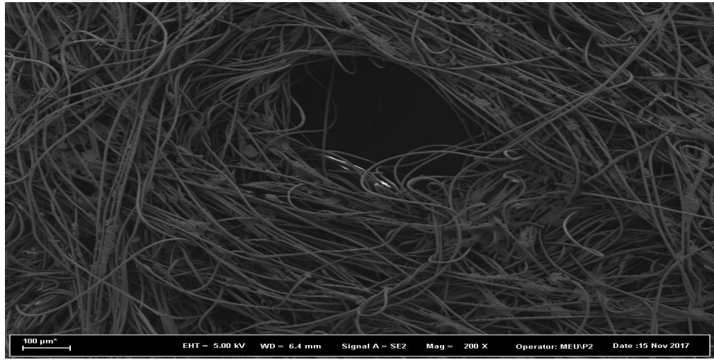
Şekil 4.15. Tarçın uçucu yağı içeren sargı bezinin 200 X oranında büyütülmüş SEM görüntüsü
