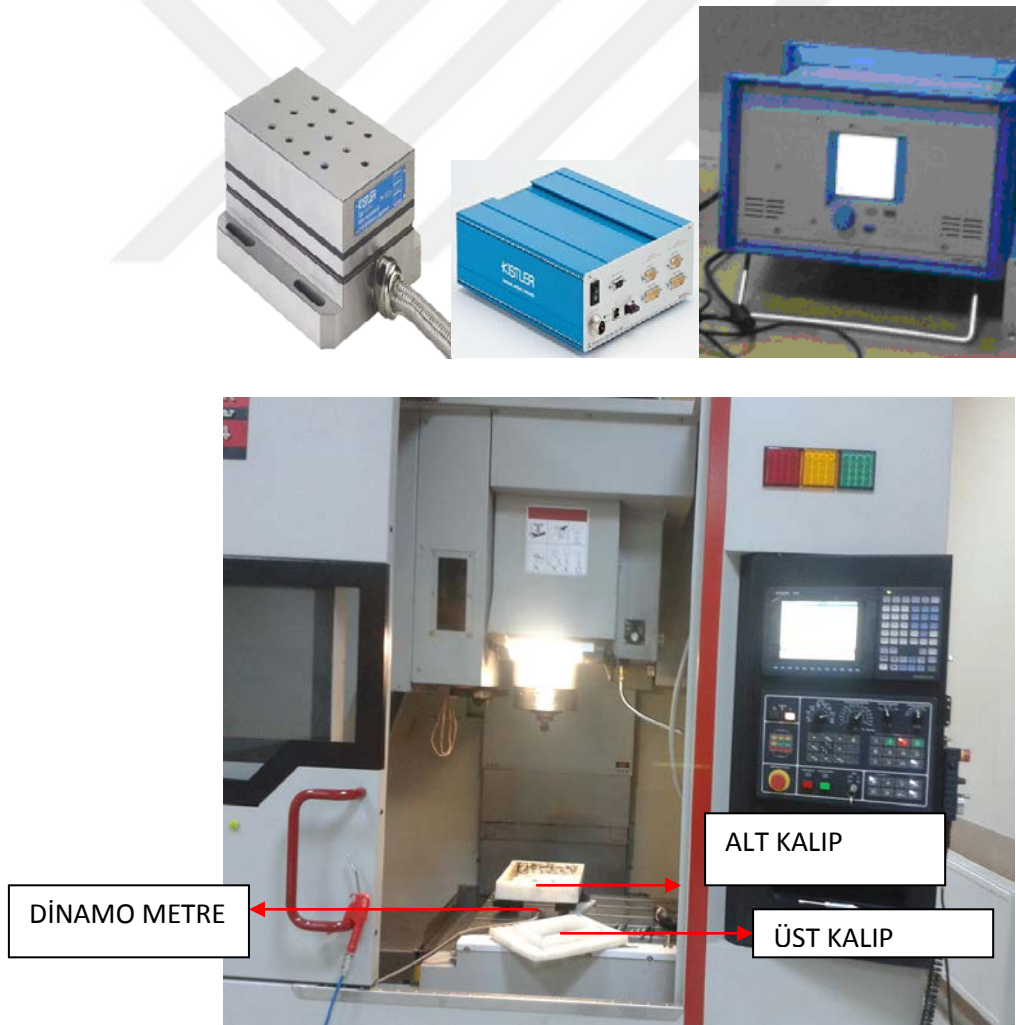
Resim 3.2. Kuvvet ölçüm sistemi ve deney düzeneđi
