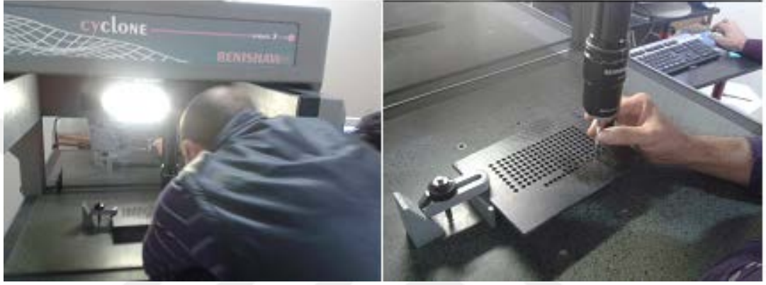
Şekil 4.9. CMM cihazında delik ölçümü
