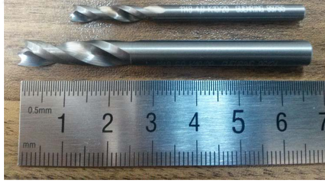
Şekil 3.5. Deneylerde kullanılan farklı çaplı matkaplar (4 ve 6 mm)
