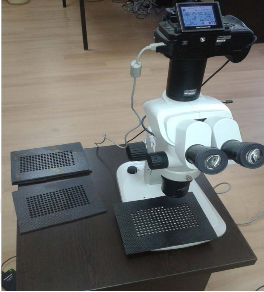
Şekil 3.9. Deformasyon ölçümlerinin yapıldığı mikroskop (Olympus SZX7 stereo trinocular mikroskop ile 12.5X büyütme)
