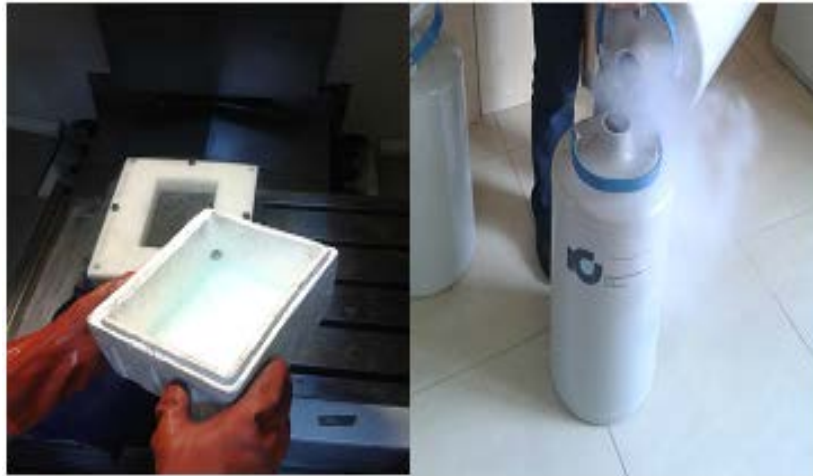
Şekil 3.1. Sıvı nitrojen muhafaza kabı ve deney kalıbına dökülmesi
