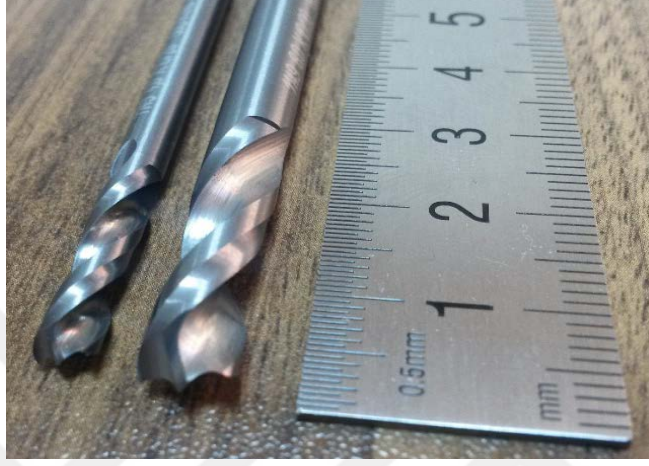
Şekil 3.4. Deneylerde kullanılan farklı çaplı matkaplar (4 ve 6 mm)
