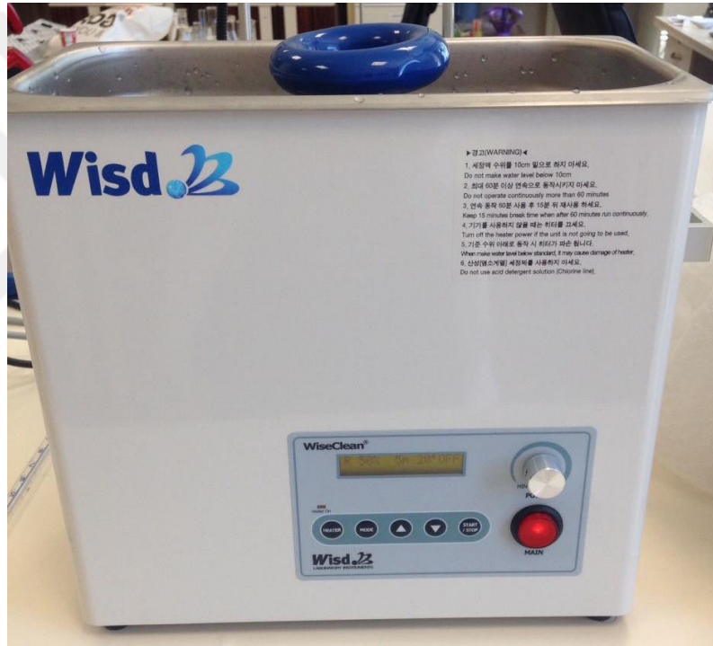
Şekil 3.2.Çalışmada kullanılan ultrasonik su banyosu
