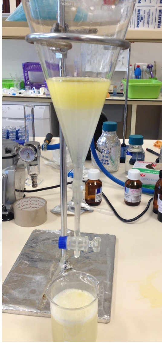
Şekil 3.5. Konvansiyonel yöntem ile nötralizasyon işlemi sonrası yağın yıkanması
