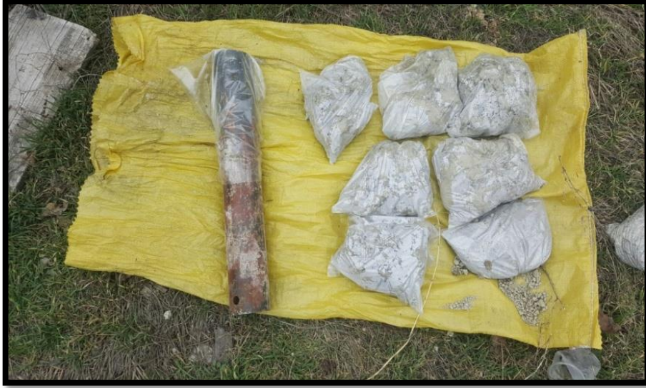
Şekil 3.4. Örselenmemiş numune (soldaki), örselenmiş numuneler (sağdakiler).
