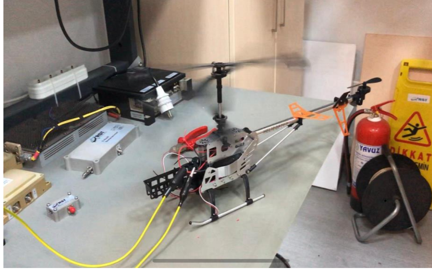
Şekil 7.19 Model Helikopter Mikro Doppler Ölçüm Düzeneği
