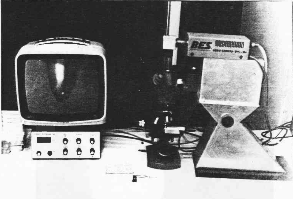
Şekil A.1. Sivri uçların incelenmesinde kullanılan elektron mikroskobu ve monitör.
