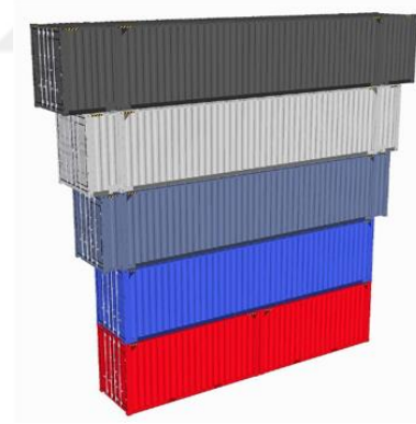
Şekil 2.2 : Tabanda 2x20'dv konteyner ve üstünde 40', 45', 48' ve 53' konteynerler
