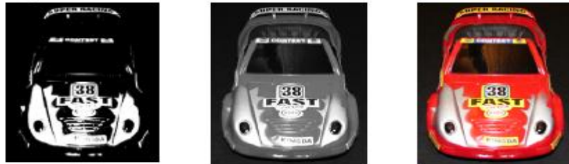
Şekil 1.20. Sırasıyla Binary, Gri Skala ve Renkli Görüntülerin Karşılaştırılması
