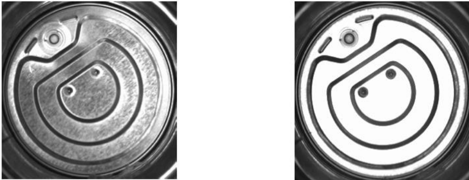
Şekil 1.25. Çevre Işıkları ve Eksen Işığıyla Aydınlatılan Nesnelerin Görüntüsü
