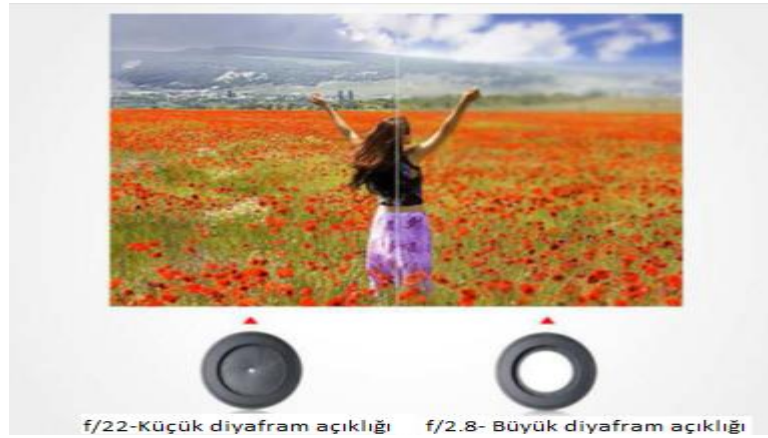
Şekil 1.12. Küçük ve Büyük Diyafram Açıklıkları, Sığ ve Derin Alan Derinliği
