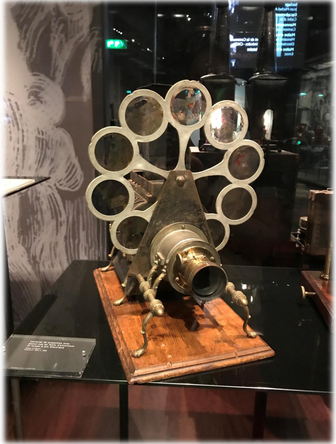
Fotoğraf 3 : Lantern de projection avec passe-vue en fonte d'aluminium et lampe à arc électrique (Geçiş görünümlü, dökme alüminyum projeksiyon feneri ve elektrikli ark lambası)
