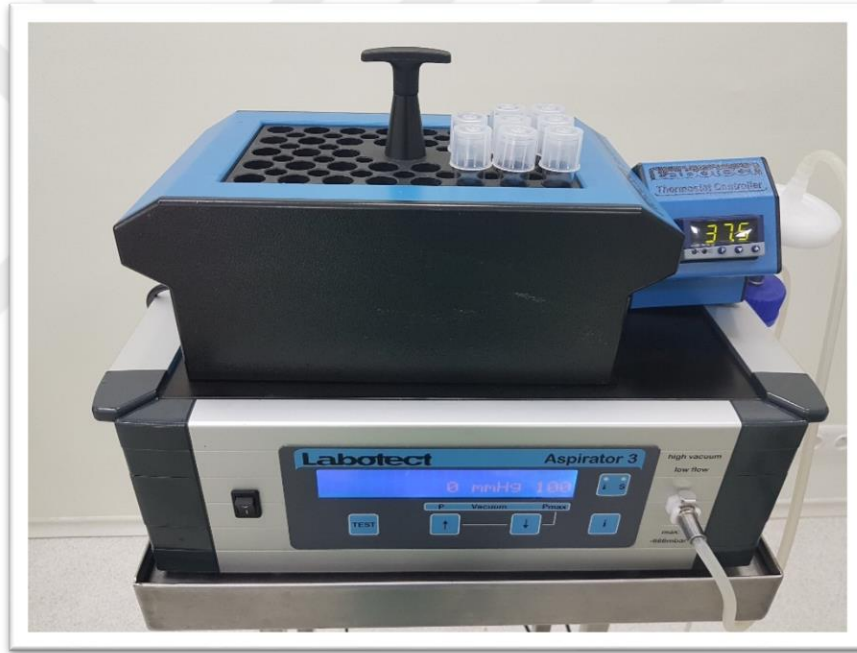
Şekil 3.5 OPU işlemi sırasında kullanılan aspiratör ve ısıtıcı blok
