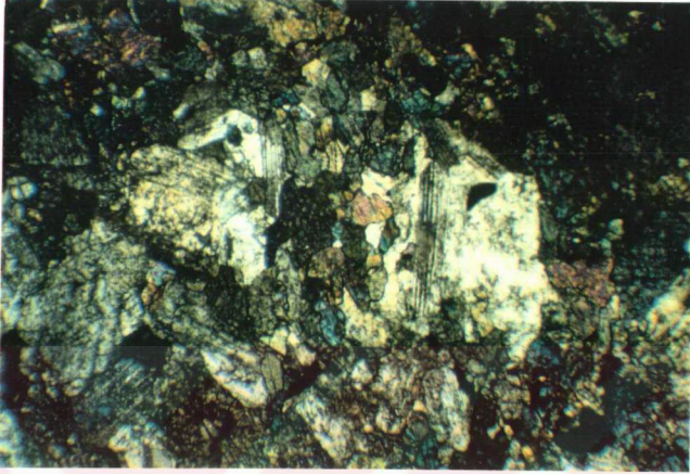
ŞEKİL: 2.10. Piroksenli Gabro Biriminin Mineralojik Bileşiminden Bir Görünüm. Ayrışmış Polisentetik İkiizli Plajiyoklaz Kristallerinin Aralarında ve Etrafında Değişik Tane Boyutuna Sahip Piroksen Kristalleri (+N×B).
