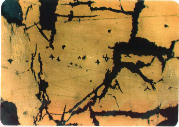
ŞEKİL: 6.12. Kalkopiritle (Ortada Sarımsı Kahverenkli) Birlikte Lameller Halinde Büyümüş Kübanit (Şeklin Sağında ve Solunda, Pembe Nüanslı) ve Kalkopiritin İçinde Sfalerit Yıldızları (Siyah renkli). Çatlaklar Gang İle Dolu (X320, Yağda).
