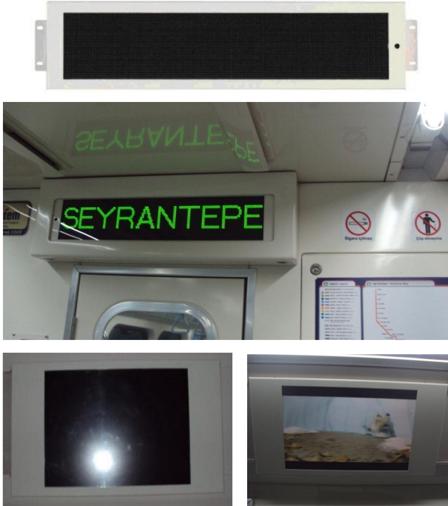
Şekil 3-3 Yolcu Bilgilendirme Panelleri (PIS & PID)
