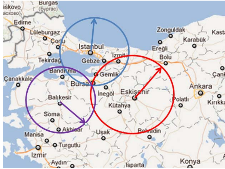
Şekil 21. Üçgenleme Methodu ile 2 Boyutlu Düzlemde Konum Hesaplama.
