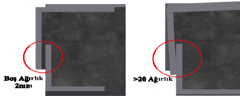
Şekil 56. 20 Kg Büyük Ağırlıklarda Mekanik Sıkışma Problemi.
