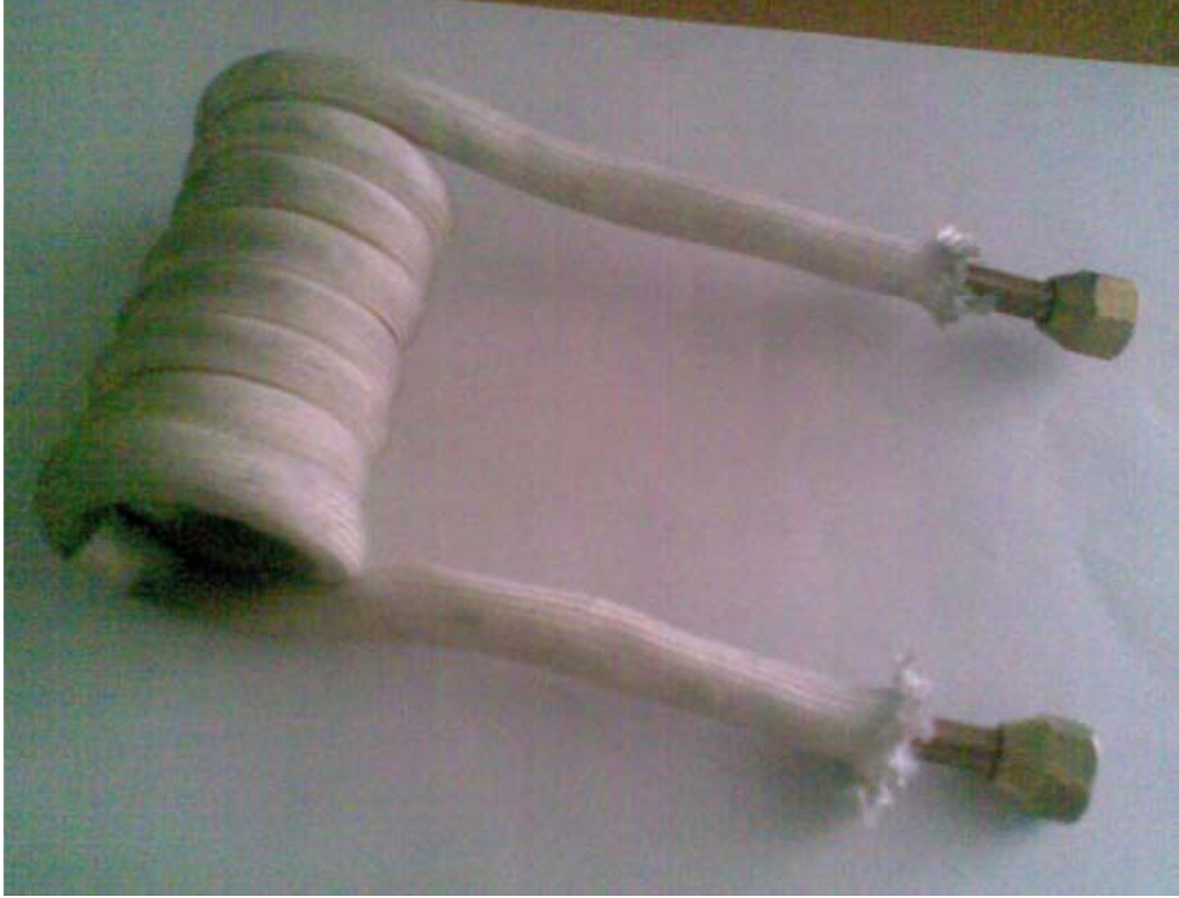
Şekil 3.5. Endüstride kullanılan örnek bir indüksiyon bobini[32]
