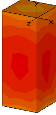
Şekil 5.2. Modelleme sonucunda elde edilen manyetik alan şiddeti 3D görüntüsü
