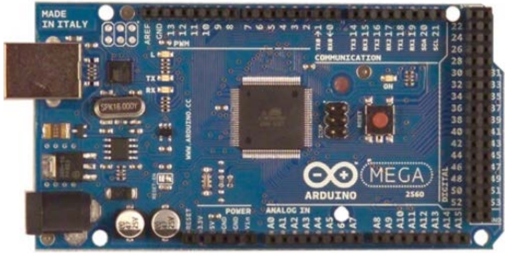
Şekil 3-5 Arduino Mega 2650 programlama kartı[15]
