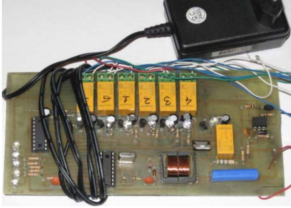
Şekil 2-11 DTMF kod çözücü[3]
