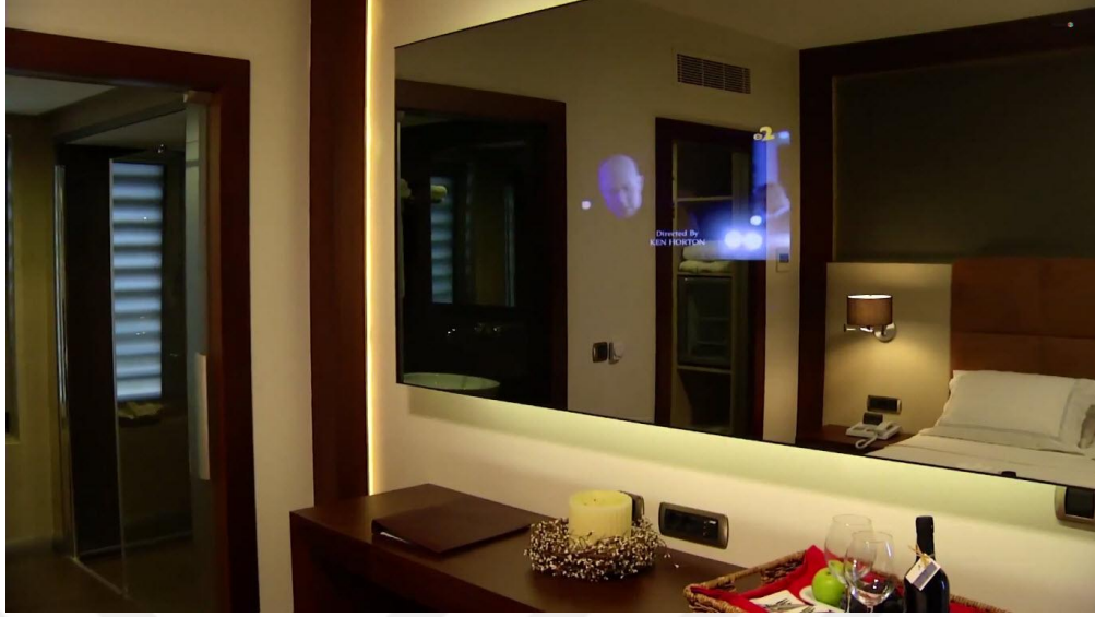
Şekil 6.100. Ortunç Hotel odalarında bulunan LCD magic mirror televizyon (ayna arkası TV uygulaması) [151].
