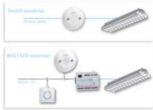
Şekil 2.32 Switch sensörler ve Bus/SCS sistemler.
