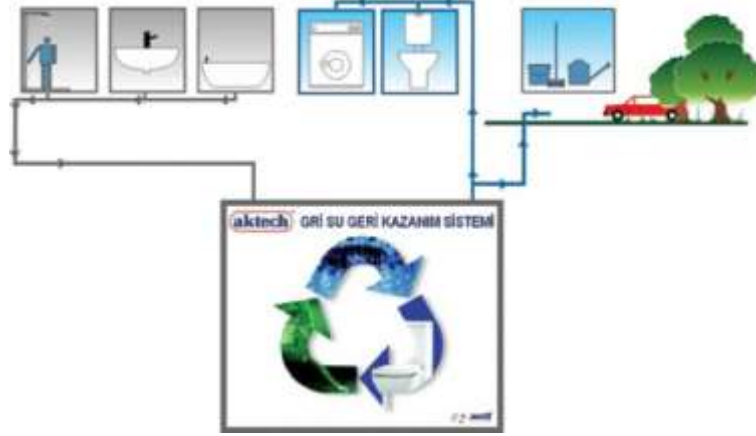
Şekil 1.10 Gri suyun konut içerisinde kullanılması
