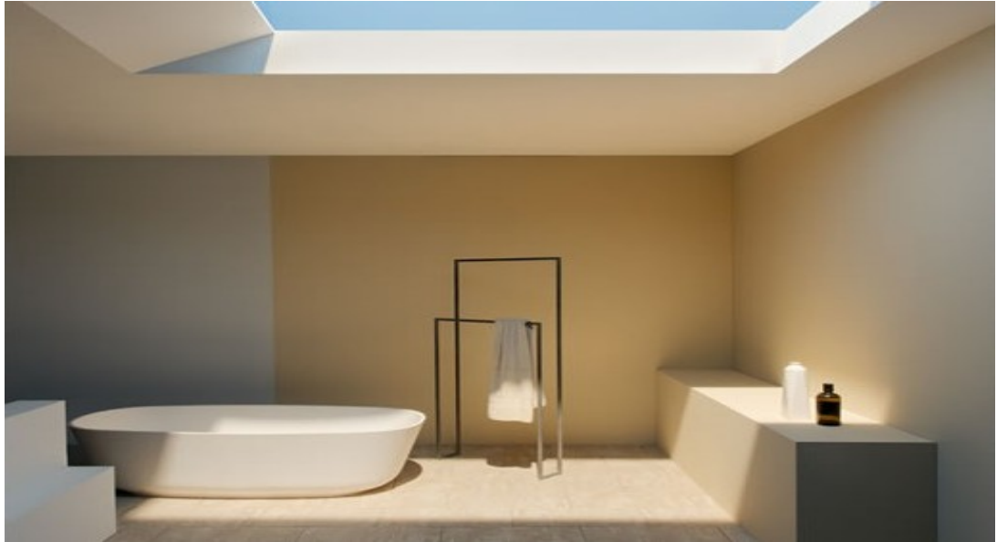
Resim 4.1.3. Doğal ışığı taklit eden yapay aydınlatma sistemleri
