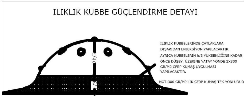
Şekil 4.2.5.1.58: Ilıklık kubbe sağlamlaştırma detayı (V.B.M. Arşivi EK-2[8])
