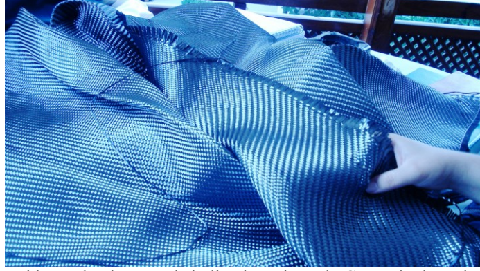
Şekil 4.2.5.1.72: Kubbe sağlamlaştırma için kullanılan tek yönlü CFRP, karbon elyaf kumaş-kanaviçe malzemesi (V.B.M. Arşivi EK-2[8])
