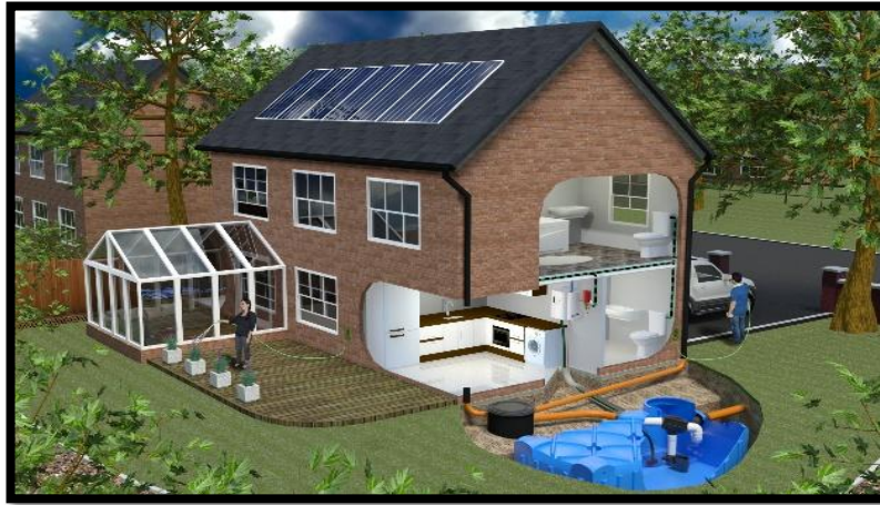
Şekil 4.18. Tek Yağmur Suyu sistemi [9]
