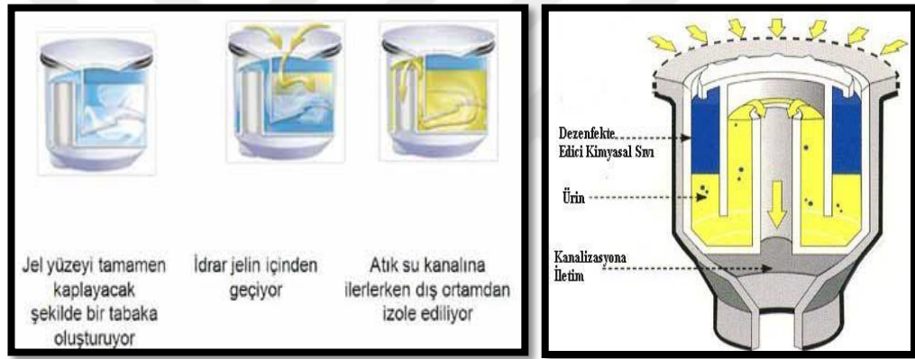
Şekil 4.39. Susuz Pisuarlarda Temizleme Sistemi (Vickers, 2001).
