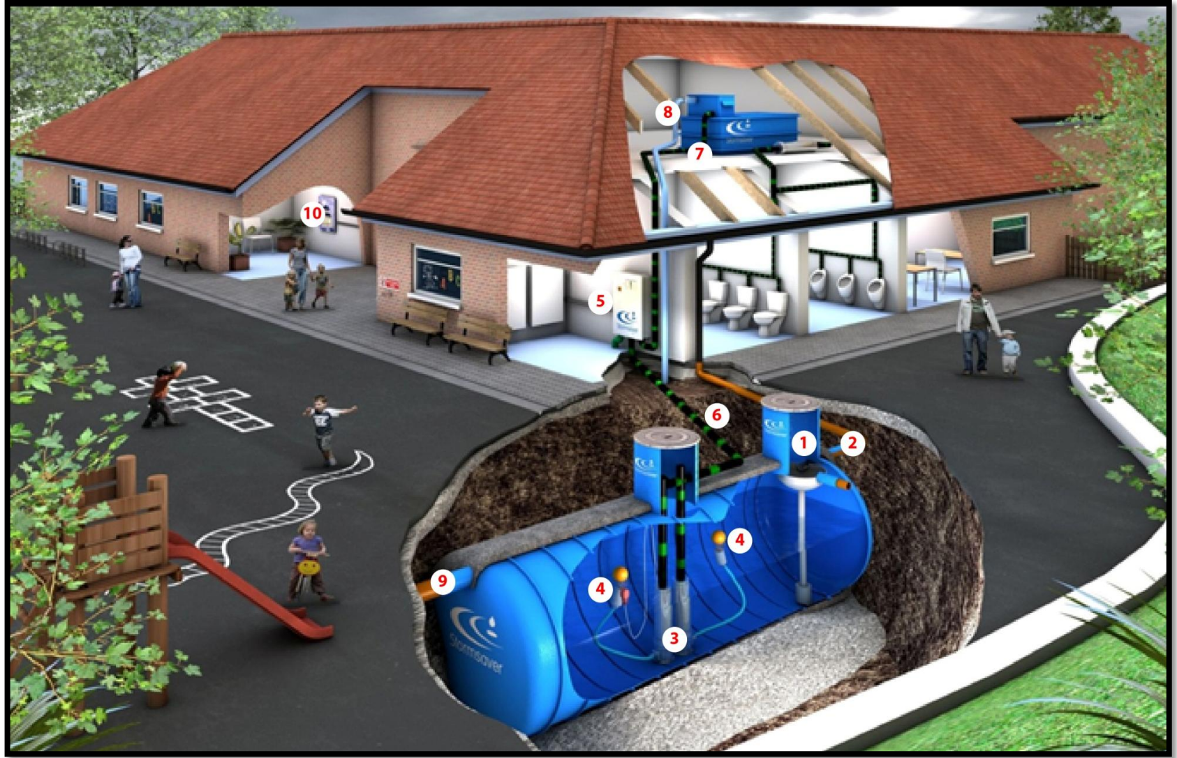
1.Filtre, 2. Yağmur suyu deposuna giriş, 3. Dalgıç pompa, 4. Yüzücü-emici filtre, 5. Kontrol Paneli, 6. Solenoid vana 7. Basınç hortumu, 8. Drenaj Borusu, 9. Taşma Borusu, 10. Ana şebeke döşemi,
