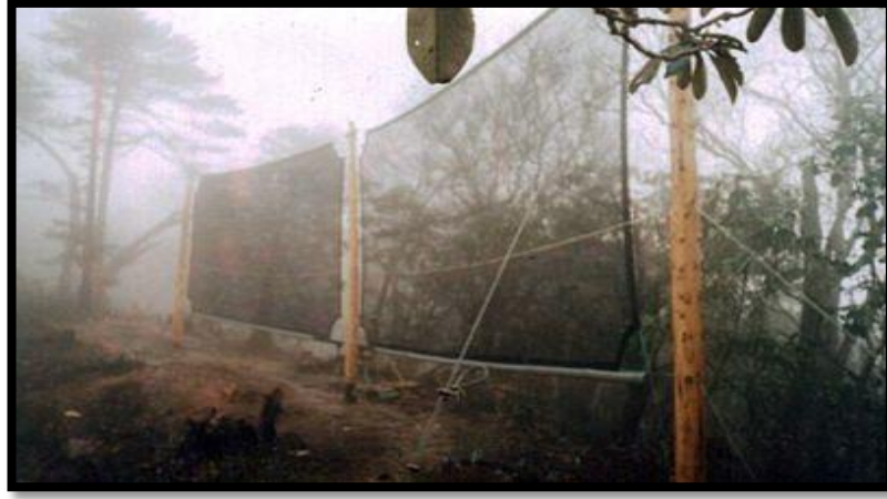
Şekil 2.9: Şili’de Sisten Su Elde Eden Dikey Kolektörler [3]
