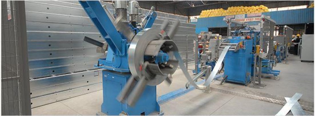
Şekil 2.5: Karkas ve makas üretiminde kullanılan roll-form makinası [16]
