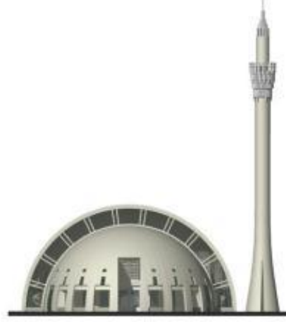
Şekil 3.2.15. Yeşil Vadi Camii 11 Parçaya Bölünmüş Işıklık [60]
