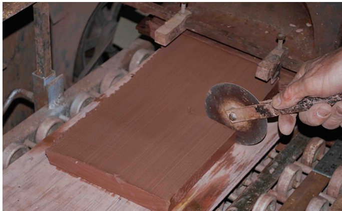
Şekil 3.1. Çekme karo yöntemiyle şekillendirilen karo.
