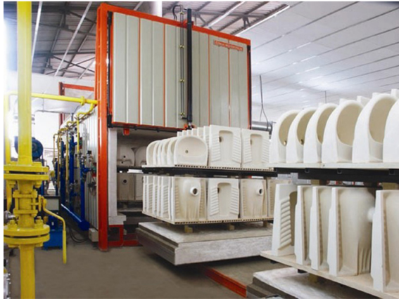
Şekil 2.17. Vitriye ürünlerini pişirmek için kullanılan fırın.
