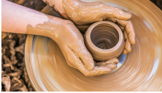
Şekil 2.14. Çamur tornasıyla şekillendirme yöntemi.
