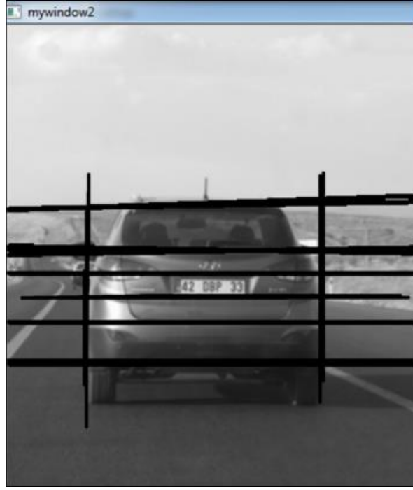
Şekil 3.16. Harris and Stephens Köşe Saptama Algoritması ile bir aracın köşelerinin bulunması
