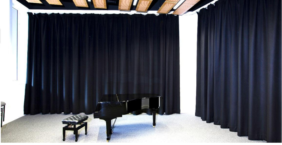
Şekil 6.27. Akustik Ses Yalıtımı Sağlayan Perde Örneği[50]
