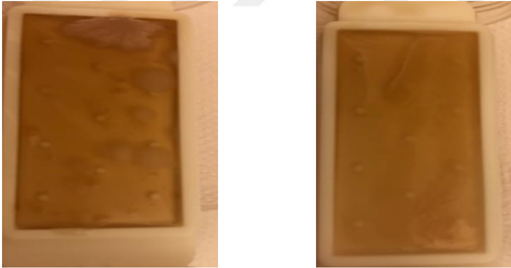
Şekil 4.3.1. Bakteri testi kitleri görüntüsü (sol resim: normal beton katkısı, sağ resim: borik asit kullanılan beton katkısı)
