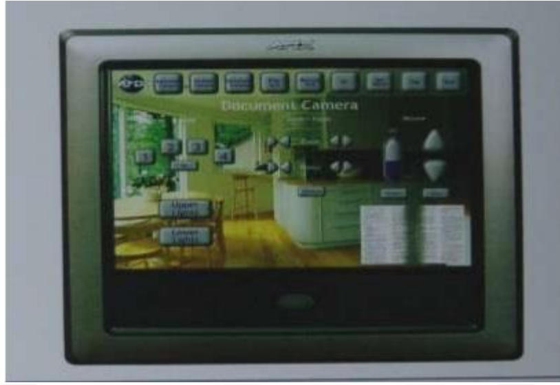
Resim 46: Kameranın touch panel ile kontrol edilmesi.
