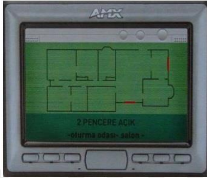
Resim 53: Plan üzerinden açık pencereleri gösteren touch panel
