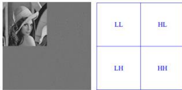
Şekil 2.10 - Dalgacık Dönüşümü Sonrası Elde Edilen Alt Bantlar
