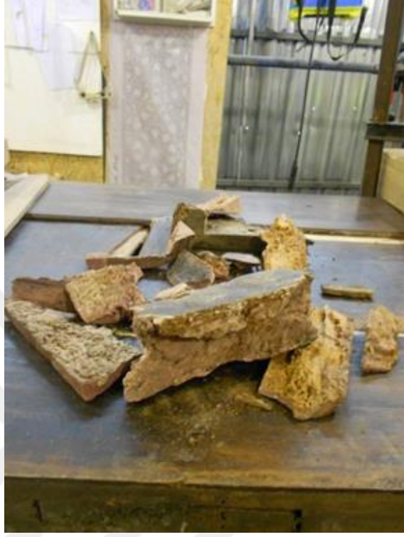
Şekil 4.67 Kündekari kapılarda araştırma aşamasında kapıların içinde ahşap renkli betonlar çıkmıştır (2012)
