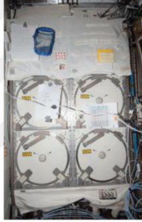
Şekil 36. Eksi 80 Derece Laboratuvar Dondurucu (MELFI-2) (NASA, Reference Guide To The International Space Station, 2015)
