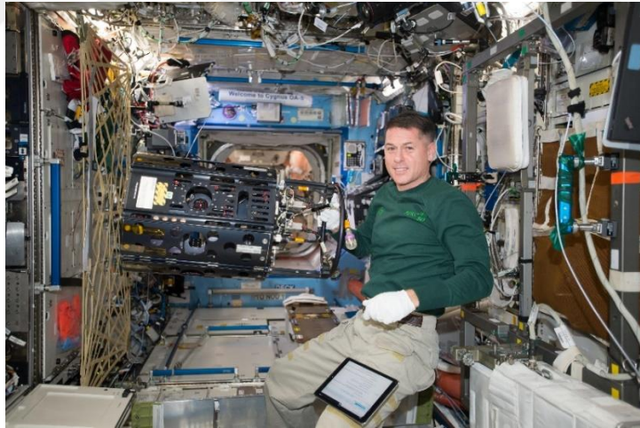
Şekil 38. Expedition 50 Komutanı Shane Kimbrough, ABD Laboratuvarında, Yanma Entegre Rafı (CIR) 'da Çok Kullanıcılı Damlacık Yanma Aparatı (MDCA) ile çalışıyor (NASA, CIR, 2019)
