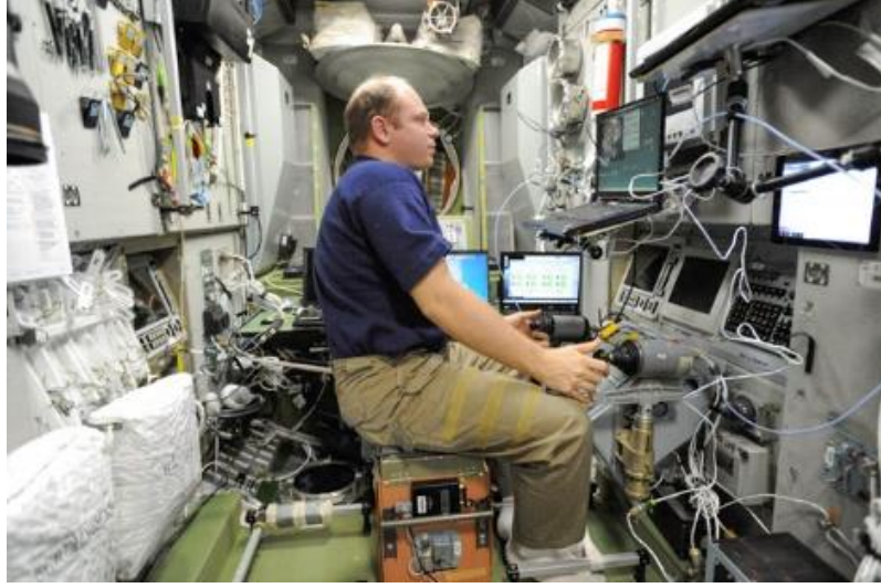
Şekil 25. Zvezda modülü içinde Komutan Oleg Kotov, TORU ile manuel yerleştirme teknikleri uyguluyor (NASA, Russian Cargo Craft Docks With Station, 2013)
