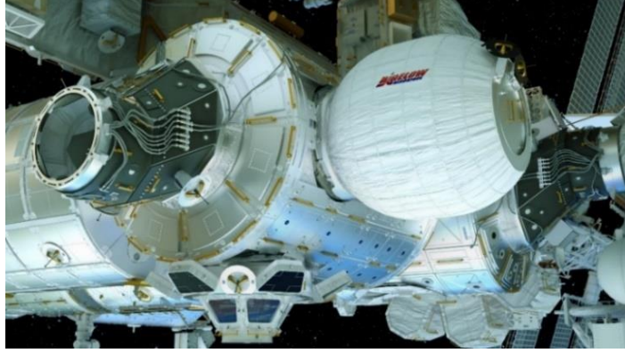
Şekil 82. Node 3 modülüne kenetlenmiş BEAM modülü, fotoğrafta içi hava ile genişletilmiş formuyla görülmektedir (soldaki beyaz modül) (NASA, Bigelow Expandable Activity Module, 2017)
