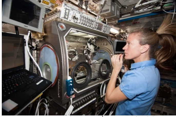
Şekil 40. NASA astronotu Karen Nyberg, U.U.İ.'nin Destiny laboratuvarında bulunan Mikrogravite Bilimi Eldiven Kutusu (MSG) ile çalışırken (NASA, Astronaut Karen Nyberg With InSPACE-3, 2013)
