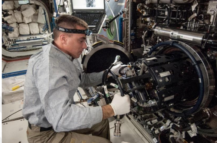
Şekil 37. Uçuş mühendisi Chris Cassidy, Çok Kullanıcılı Damlacık Yanma Aparatı (MDCA), Oda Takma Tertibatı (CIA) ile çalışarak, bir ABD MDCA Yakıt Deposu'nu, Yanma Entegre Rafı'ndan (CIR) çıkarmak için çalışıyor (NASA, CIR, 2019)
