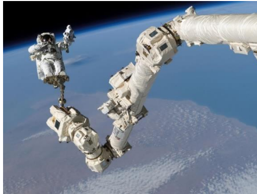
Şekil 29. Canadarm2 robotik kolu, EVA görevinde olan bir astronotu taşıırken (NASA, Human Robotic Systems, 2012)
