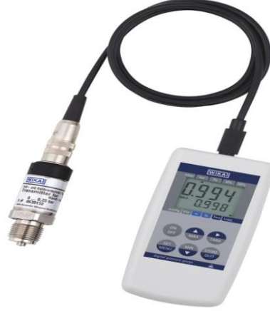
Şekil 3.5. Manometre - WIKA CPH 6200-S2
