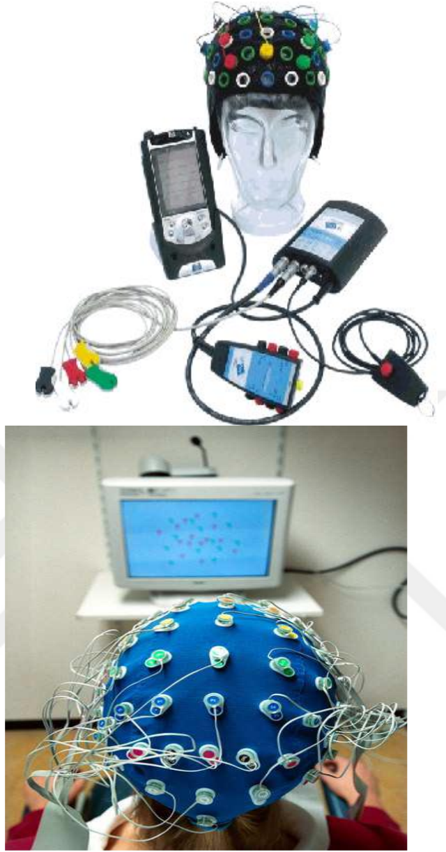
Şekil 21. EEG Sistemlerinde Kullanılan Aletler. Ölçüm Sistemi Birkaç Elektrot,
