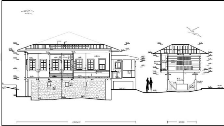
Şekil 3.51. Aydınoğlu evi ve serenderin kesiti (Güler, 2012:201)
