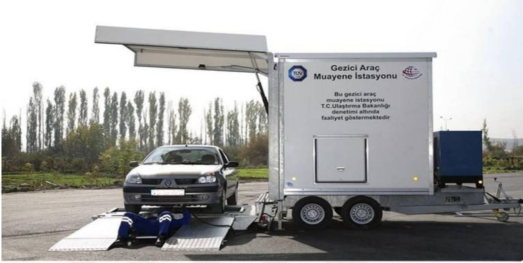
Şekil 8. Mobil Araç Muayene İstasyonu – Kanal Yapısı P1 Kaynak: TÜVTÜRK
