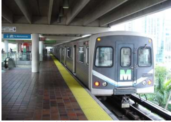
Şekil 4.49. Miami'deki metro istasyonundaki peronun güneş ışığından faydalanabilecek şekilde yerüstünde konumlanması (Url-17)
