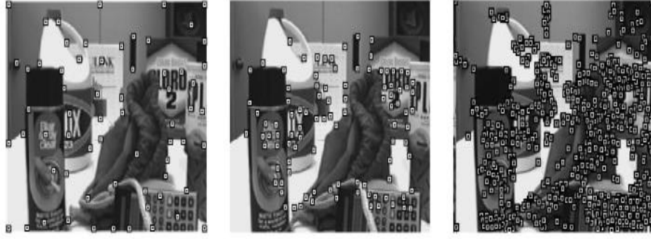
(a) (b) (c) Şekil 3.7. Özellikli nokta tanımlayıcılarının buldukları noktalar a) Harris algılayıcısı b) KLT c) SIFT
