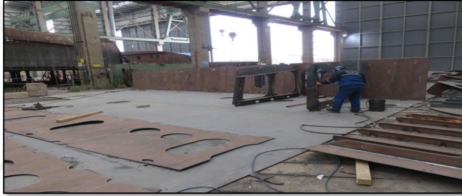
Resim 4-66: Kaynak ile birleştirilen parçalar (Bilal Ahmet KOLAY, 2019)
