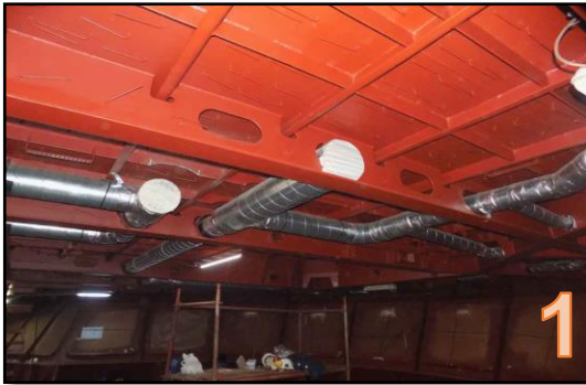
Resim 4-82: Hafifletme deliklerinden geçen hava kanalı & HVAC odası (Bilal Ahmet KOLAY, 2019)
