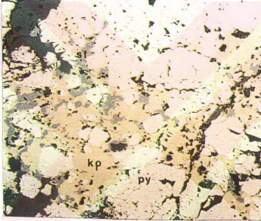
Resim 3.(Büy.200) Pirit (py) Tanelerinin Boşluklarında İzlenen Kalkopirit (kp) ve Sfalerit (sf) (1 cm= 50 µm )
