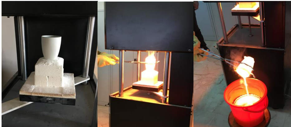
Resim 3: E kodlu firitin laboratuvar ortamında üretim aşaması.
