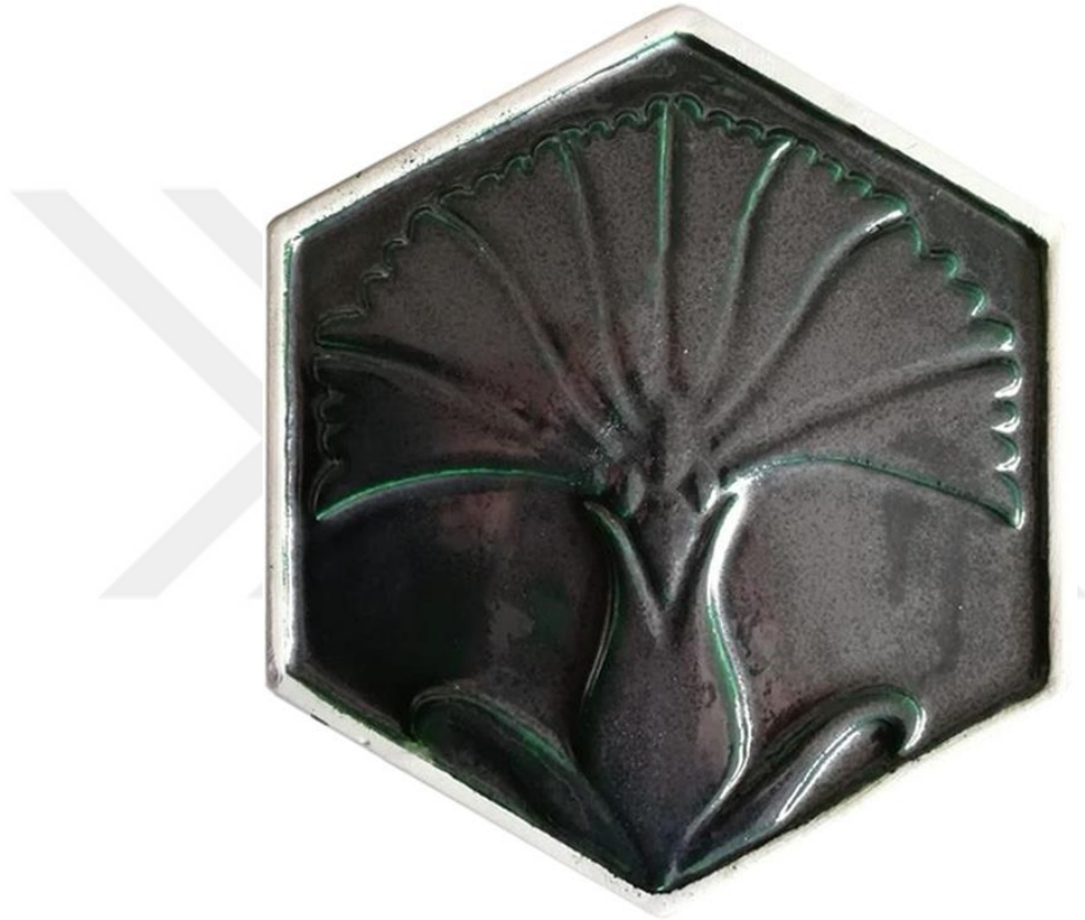
Resim 14: AD9-C10 sırnın 20x20 boyutundaki duvar panosu uygulaması.
