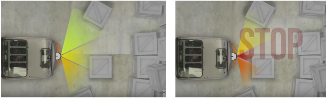
Şekil 3.2. Mesafe algılayıcı sensörlerin çalışmasına örnek (Sis-safety, 2017).
