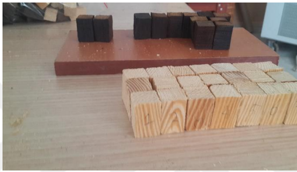
Şekil 2.2. Basınç direnci deneyi örnekleri
