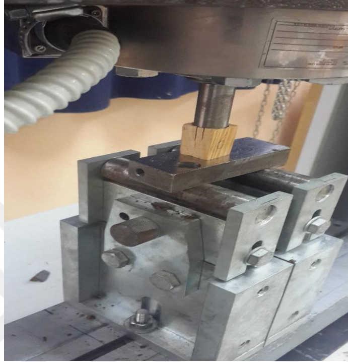
Ek 1.12. 4 tonluk üniversal deney cihazında basınç direnci deneyi
