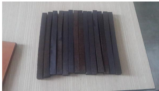
Şekil 2.1. Eğilme direnci deneyi örnekleri.
