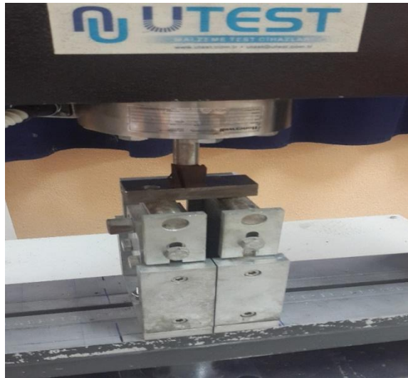
Ek 1.8. 4 tonluk üniversal deney cihazında basınç direnci deneyi
