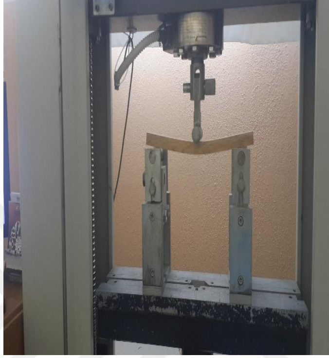
Ek 1.8. 4 tonluk üniversal deney cihazında basınç direnci deneyi
